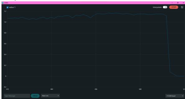
Figura 2: Gráfico de medições do sensor EDA (eletrodos no pulso), tendo a condutância em micro siemens ( $\mu\text{S}$ ) por amostras (Imagem elaborada pelo autor).
