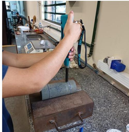
Figura 1- Esclerômetro em uso nas dependências do Lab. de Mecânica das Rochas do Depto. de Geotecnia da EESC/USP.
