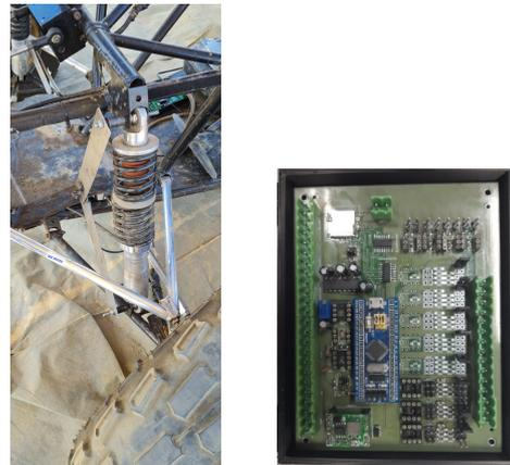
Figura 2: Sensor de curso do amortecedor e placa de aquisição de dados.
