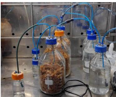
Figura 1: Sistema de compostagem montado em laboratório.
