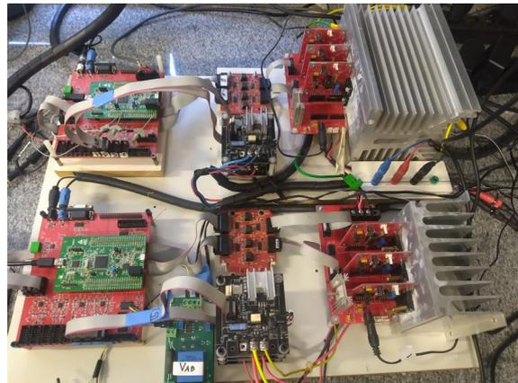
Figura 3: Bancada com inversores trifásicos para controle da MSIP e da máquina de indução.
