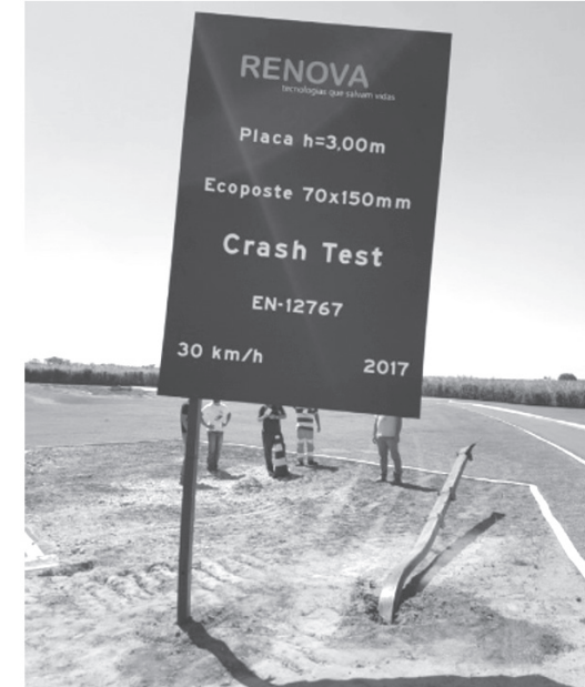
Figura 4.12 – Exemplo de suporte de placa colapsível.
