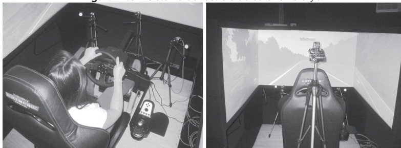
Figura 14.5 – Sistema de rastreamento do olhar SmartEye .
