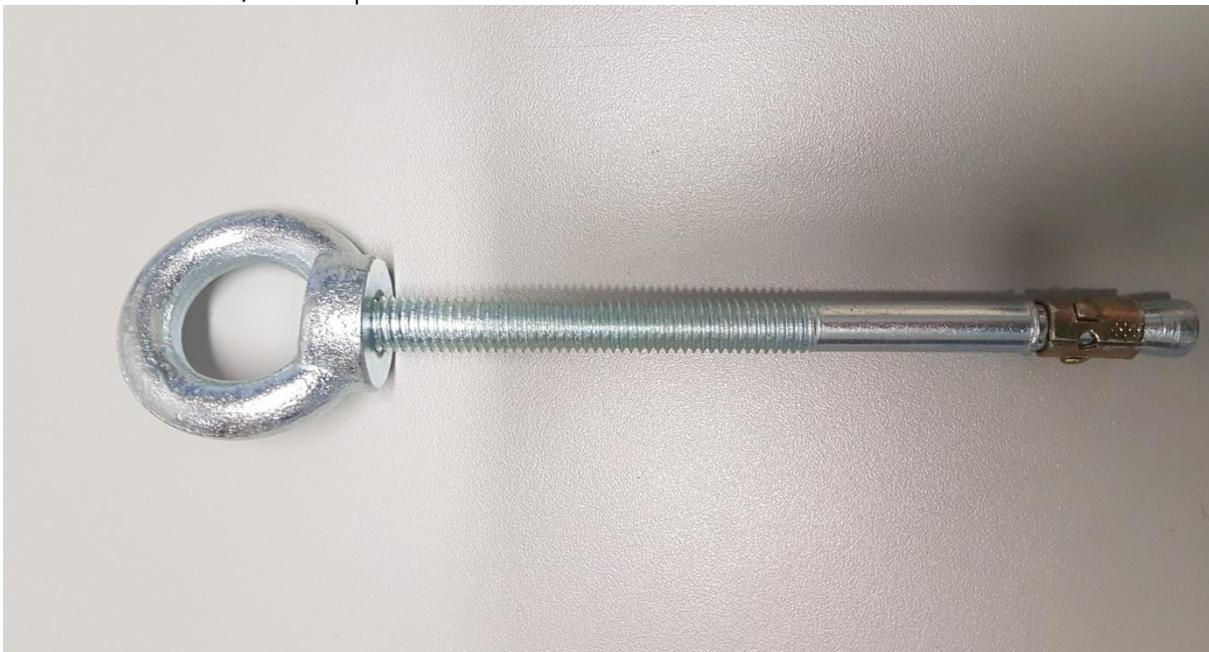
Os chumbadores devem ser instalados em todos os níveis de pavimentos e a cada 3,0 metros na horizontal, fixados em estrutura de concreto do prédio.
